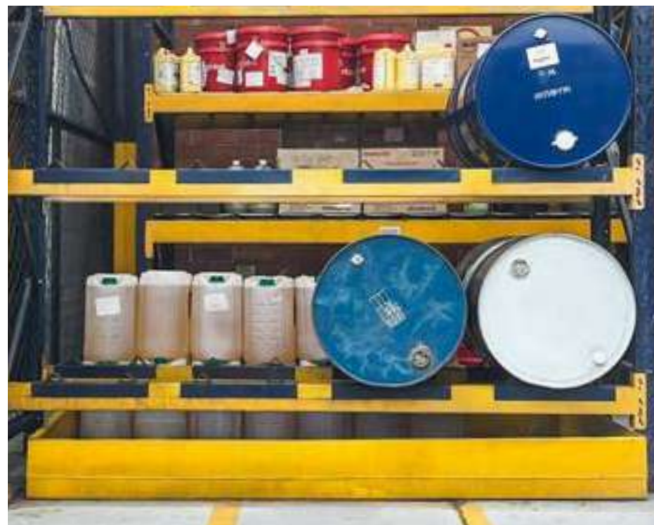
Spill containment dike.
